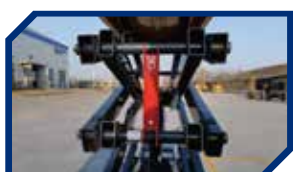
安全检修支架
